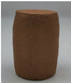
图 11 G-X 改良土三轴剪切后试样
