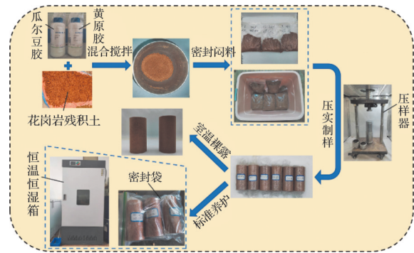
图3 试样制备与养护过程
