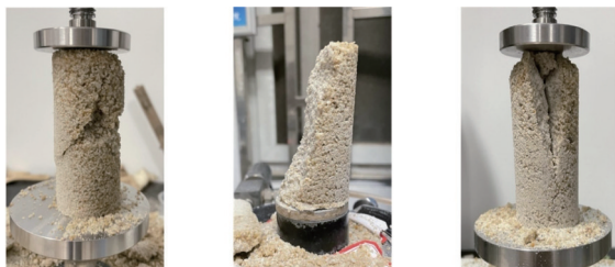
图 8 宏观破坏模式的室内试验结果
