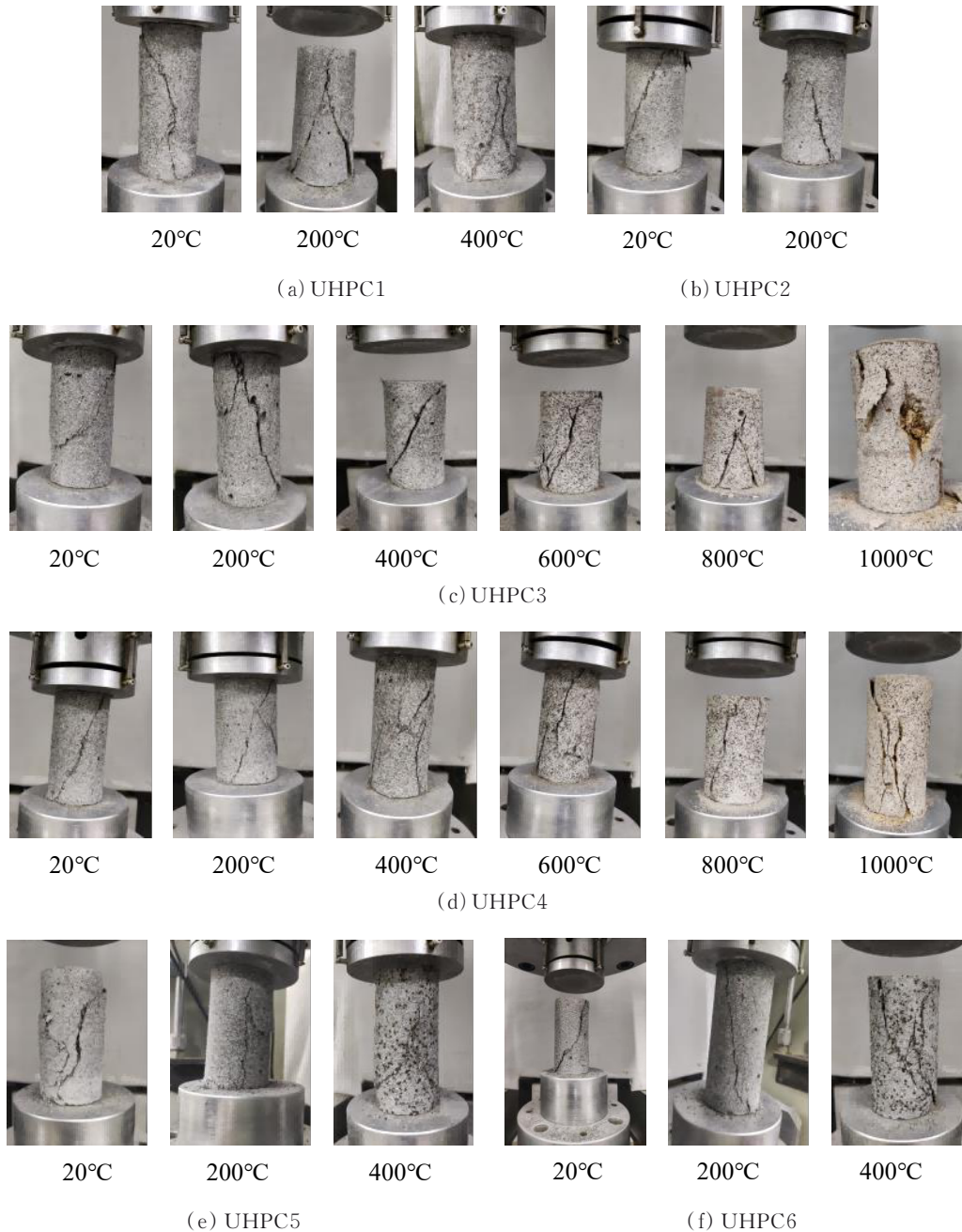
图5 UHPC圆柱体抗压试验破坏特征
