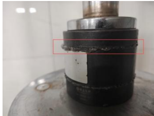
图5 硅粉含量高于10%时试样溢出
