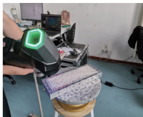
图 2 注浆完成后对裂隙面进行三维激光扫描
