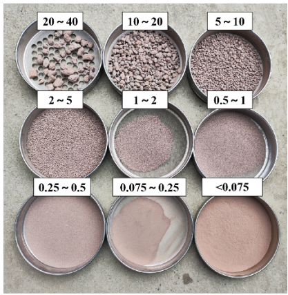
图 2 试样筛分结果图(单位:mm) Fig.2 Sieve analysis results plot (unit: mm)
