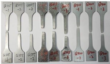
图 3 材性试验试件 Fig.3 Material property test specimens
