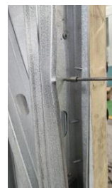
(b) 受压侧边柱下部翼缘外张屈曲
