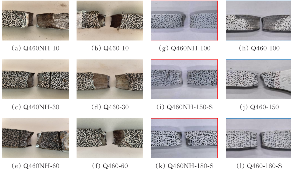
图 9 典型腐蚀时段下 Q460NH、Q460 钢材断口形貌
