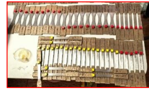
图5 试件夹持段防腐处理
