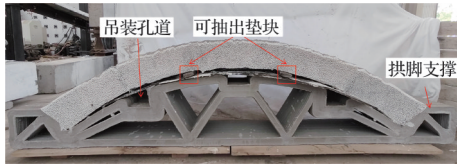
(b) 3D打印混凝土临时支撑拼装法
