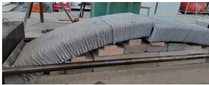
(a) 垫块支撑拼装法
