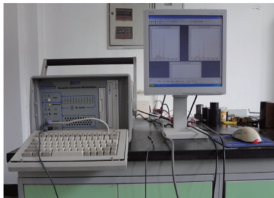
图 2 PCI-2 型声发射仪 Fig. 2 PCI-2 acoustic emission detector
