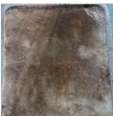
(b) 降雨冲刷中的试样
