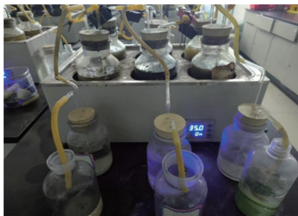
图1 鸡粪厌氧消化装置
