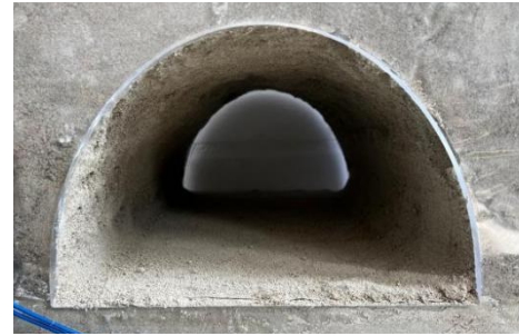
(a) 隧道扩挖后毛洞工况
