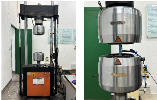
图 7 INSTRON 材料试验 1342 系统 Fig. 7 INSTRON Material test 1342 system
